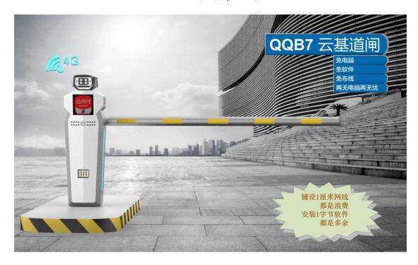
QQB7 小泊机器人,是配备 300 万像素高清车牌识别摄像机、智能补光系统、智能语音合成、7 色高亮 LED 显示屏以及快速平稳的直流无刷道闸的一种车道智能管理设备,具备 4G 无线通讯通信网络,方便快捷获取云端赋能,随着云端功能的持续更新,持续迭代,小泊机器人的功能也会跟随云端的提升而更加强大。无线遥控确认放行车辆,云端详细记录每次确认的通讯记录;小泊机器人能够判断车辆移动方向,具备倒车关闸、会车智能仲裁等精细化车道管理功能。小泊机器人不依赖本地管理电脑,从云端获取停车管理服务,能够独立管理车道,控制道闸开启和关闭,是一种精巧完美的停车场出入口车辆管理智能设备。
